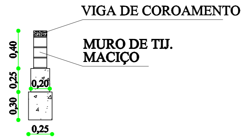
DETALHE CORTE MURO DE TIJ. MACIÇO
